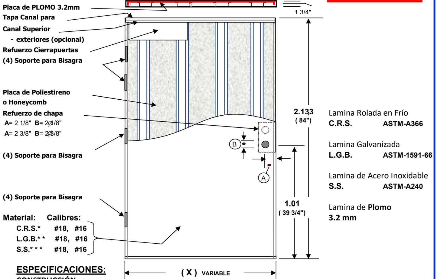
Las **PUERTAS DE RAYOS X, DOORLOCK** están construidas en dos piezas (caja y tapa) con perfiles integrados para otorgar seguridad en el ensamble, en sus extremos se unen por electro-fusión TIG a los canales superior e inferior para estructurar y fortalecer el cuerpo de la puerta. Tiene cuatro soportes para bisagra de 5/32" de espesor, electro-fusionadas a la caja, para alojar y sujetar las bisagras de 4 1/2" x 4 1/2".
